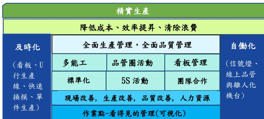
圖 2：工業 4.0 精實生產的結構
