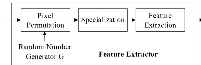
圖 3：修正後的特徵萃取器包含三個模組
